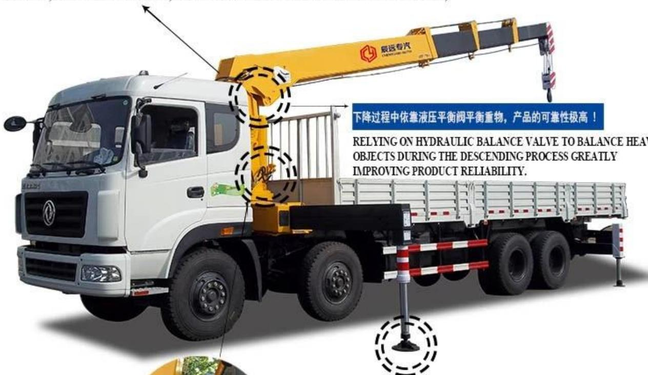
下降过程中依靠液压平衡阀平衡重物，产品的可靠性极高！
